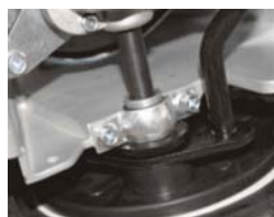
Dvojité masivní uložení ložiska nápravy převodovky
